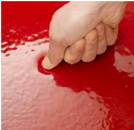
Fig 9: Fond de cuve élastique
