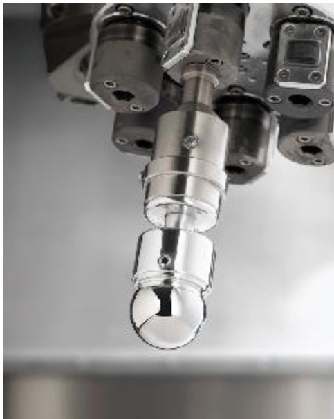
Fig 6 : Support d'outil incliné, rotation de l'outil identique
