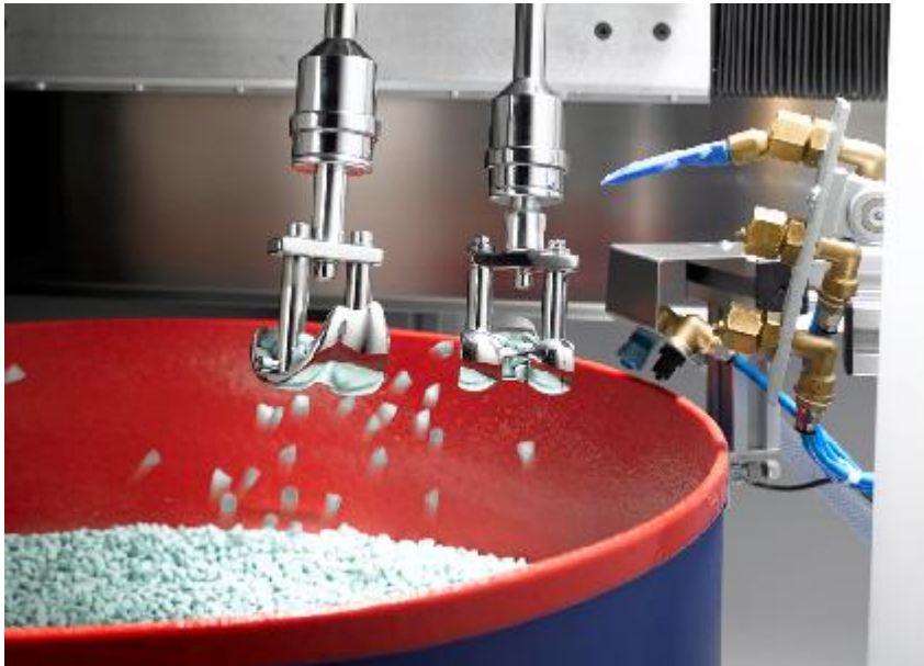
Fig 10 : Dispositif d'évacuation des médias
